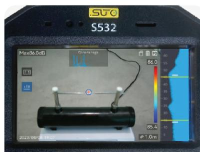
S532将提供无缝操作，自动识别局部放电类型和强度，在屏幕上显示结果。
