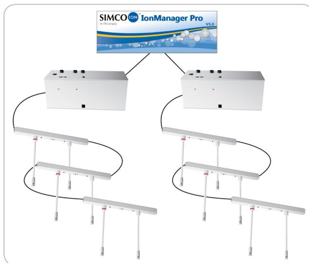
离子产生器连接到 5582 控制台, 通过 IonManager Pro 软件, 可发送电子邮件通知到工厂监控系统或管理人员。
